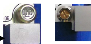
Coupelle plombée protégeant l'accès aux fonctions métrologiques
