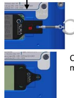
Clé SUPERVISEUR, magnétique ou RFID
