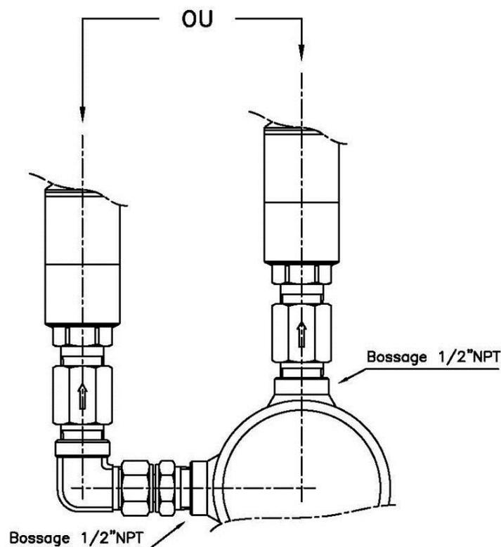
Raccorder le capteur de pression, équipé de l'amortisseur hydraulique, sur la tubulure par l'intermédiaire d'un bossage 1/2"NPT et assurer la bonne étanchéité du montage.
