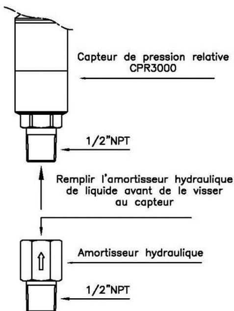
Visser l'amortisseur hydraulique et assurer l'étanchéité
