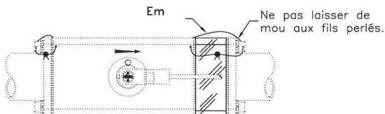
Pour le scellement des kits (EmX), et tous les autres scellements, respecter le schéma du CET mentionné sur la plaque d'identification de l'ensemble de mesurage.
