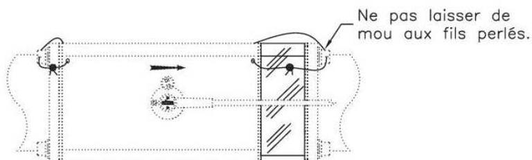
Pour le scellement des kits (Em), et tous les autres scellements, respectez le schéma du CET mentionné sur la plaque d'identification de l'ensemble de mesurage.
