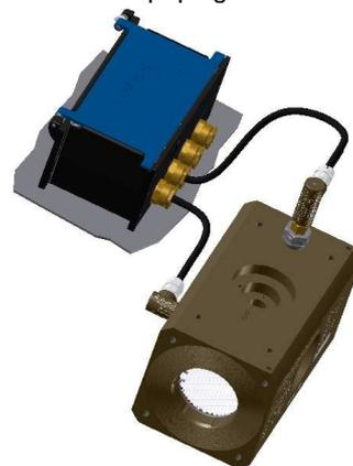
La position du piquage 3/8" NPT peut être différente suivant les types de turbines.
