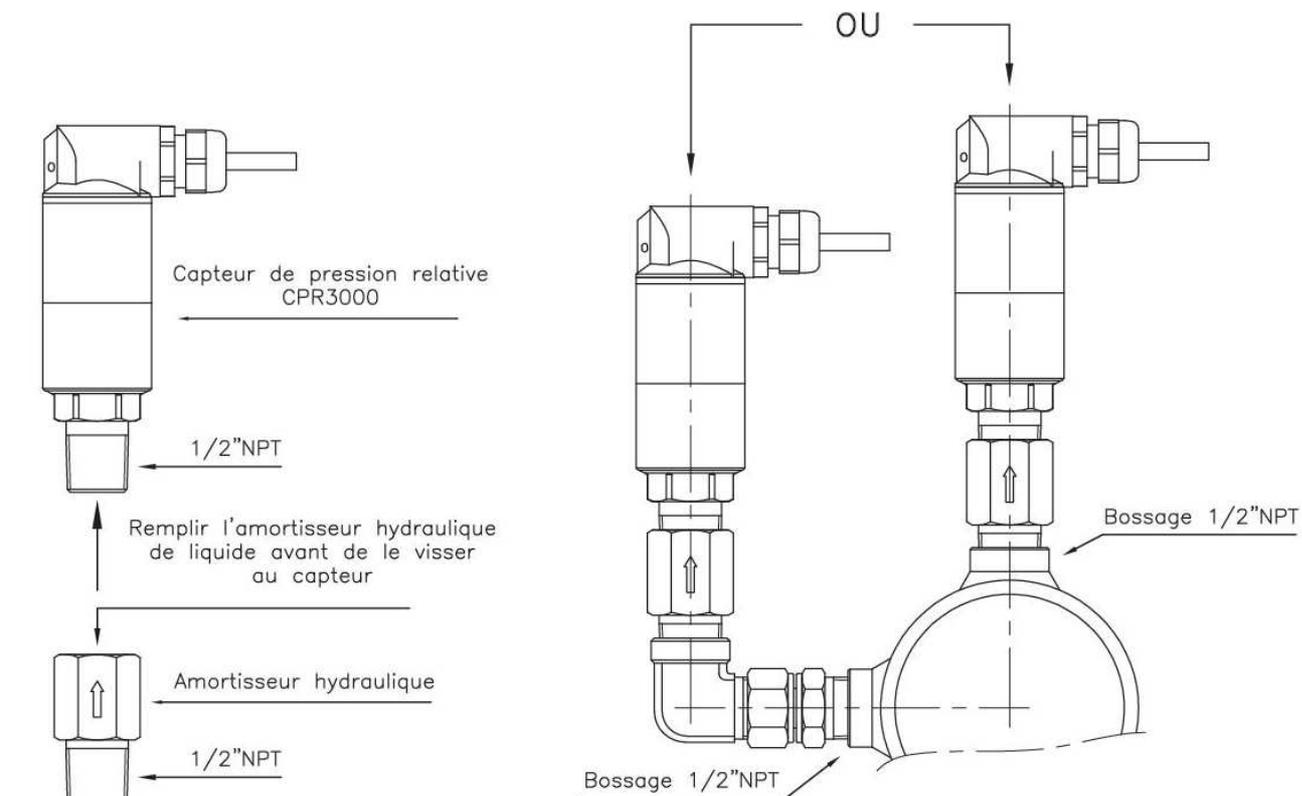
Visser l'amortisseur hydraulique et assurer l'étanchéité
