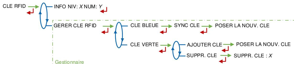
**INFO** : Affichage du niveau et de l'identifiant de la clé RFID présente sur l'afficheur (clé bleue : Niveau1-Chauffeur, clé verte : Niveau2-Gestionnaire, clé rouge : Niveau3-Maintenance)
