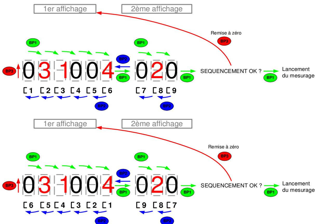
Pour intégrer un compartiment à la livraison, il faut se déplacer sur le digit du compartiment correspondant avec le BP1 (vers la droite) ou BP2 (vers la gauche), puis valider avec le BP3.
