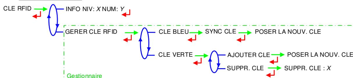
**INFO** : Affichage du niveau et de l'identifiant de la clé RFID présente sur l'afficheur (Niveau 1/Bleu/Chauffeur, Niveau 2/Vert/Gestionnaire, Niveau 3/Rouge/Maintenance)
