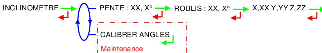
**PENTE...** : Permet de visualiser les angles d'inclinaison du camion et les données brutes de l'inclinomètre en g.
