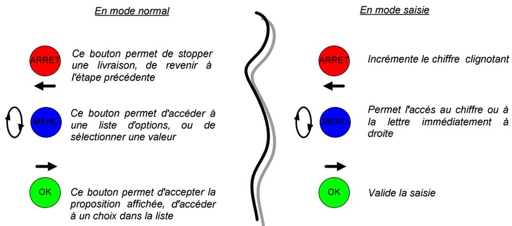
Le dispositif calculateur-indicateur MICROCOMPT+ assure l'opération de mesurage et gère les défauts liés à l'ensemble de mesurage.
