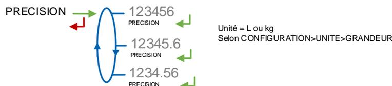
**DEBIT :** Choisir l'unité de la quantité affichée et imprimée. L'unité dépend du choix fait au menu CONFIGURATION>UNITE>GRANDEUR (mesure d'un volume ou d'une masse).
