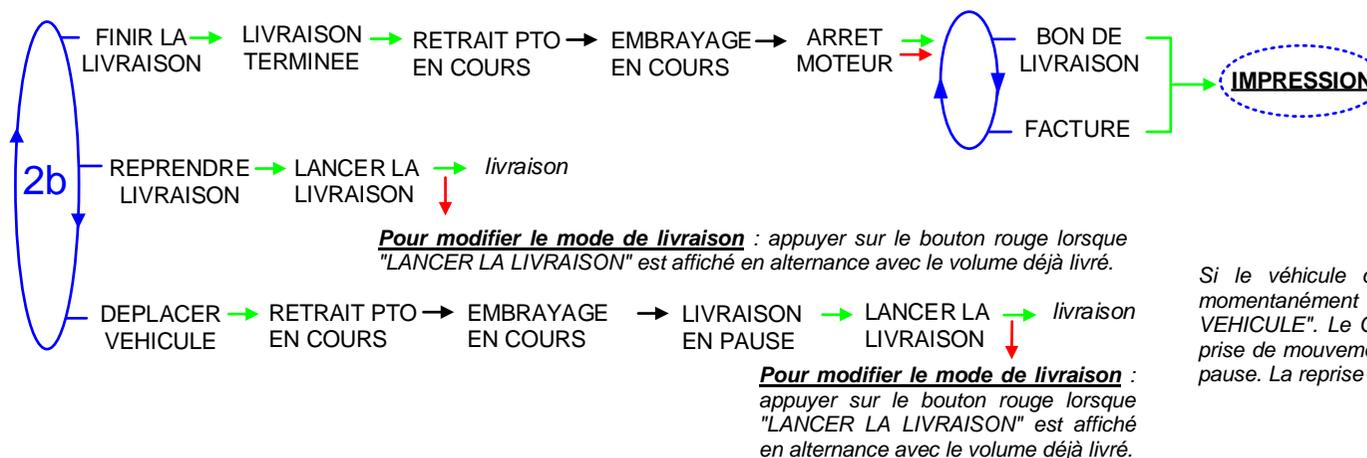
Si le véhicule doit être déplacé, la livraison peut être momentanément interrompue en choisissant "DEPLACER VEHICULE". Le CMA TRONIQUE commande le retrait de la prise de mouvement, le débrayage de la pompe et se met en pause. La reprise de la livraison se fait par appui sur le bouton
