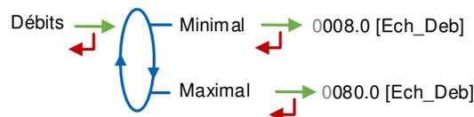
**Minimal** : Débit minimal métrologique de l'ensemble de mesurage suivant l'unité de débit configurée (Configuration>Echelons>Débits)
