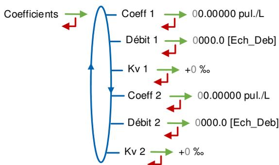
Lorsque les paramètres Débit 1 et Débit 2 sont nuls, les paramètres Coeff 2 et Kv2 ne sont pas appliqués.
