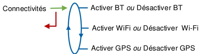
**Activer BT** : Activer ou désactiver la connexion Bluetooth. Le Bluetooth se met en veille automatique après deux minutes d'inactivité hors connexion et après dix minutes d'inactivité en connexion
