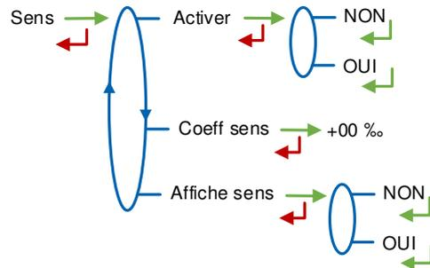
**Activer** : Choisir ON si l'UNI-2 est destiné à détecter le sens de coulage chargement et s'il est capable d'additionner les volumes dans un totalisateur spécifique (volumes non garantis)
