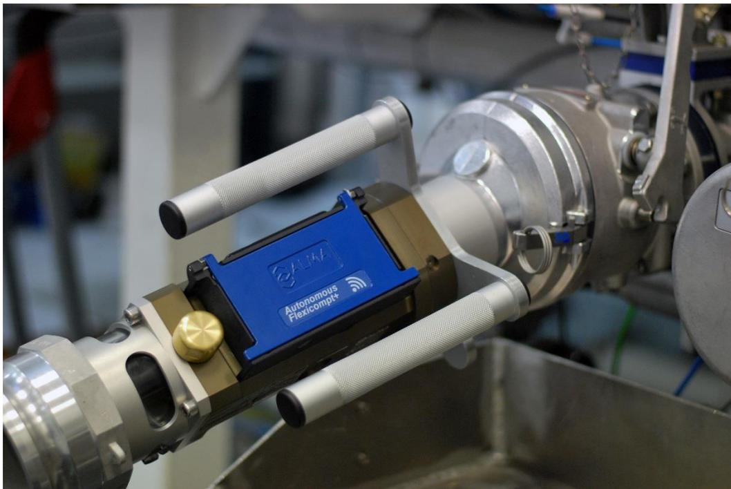
**NOTA** : Lorsque le FLEXICOMPT AUTONOME+ est utilisé avec de l'AdBlue®, il doit être rincé à l'eau après chaque utilisation pour le nettoyer et assurer son bon fonctionnement. Ceci évite la formation de cristaux.
