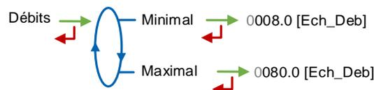
**Minimal** : Débit minimal métrologique du FLEXICOMPT AUTONOME+ suivant l'unité de débit configurée (Configuration>Echelons>Débits)
