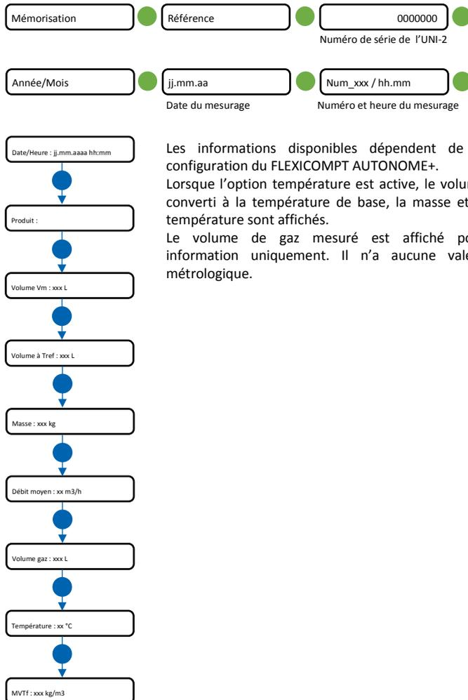
Les informations disponibles dépendent de la configuration du FLEXICOMPT AUTONOME+. Lorsque l'option température est active, le volume converti à la température de base, la masse et la température sont affichés. Le volume de gaz mesuré est affiché pour information uniquement. Il n'a aucune valeur métrologique.
