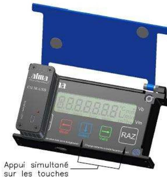
**ATTENTION** : L'appui non simultané sur ces 2 boutons poussoirs sélectionne le produit suivant. Vérifier le produit souhaité avant un nouveau dépotage.
