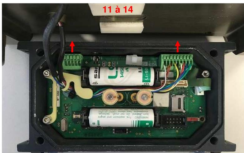
La pièce support permet de diminuer le risque de pincer les fils ou le sachet au montage de l'UNI-1.
