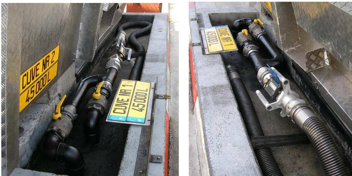
Exemple d'installations non conformes du FLEXICOMPT AUTONOME+ en position fixe :
